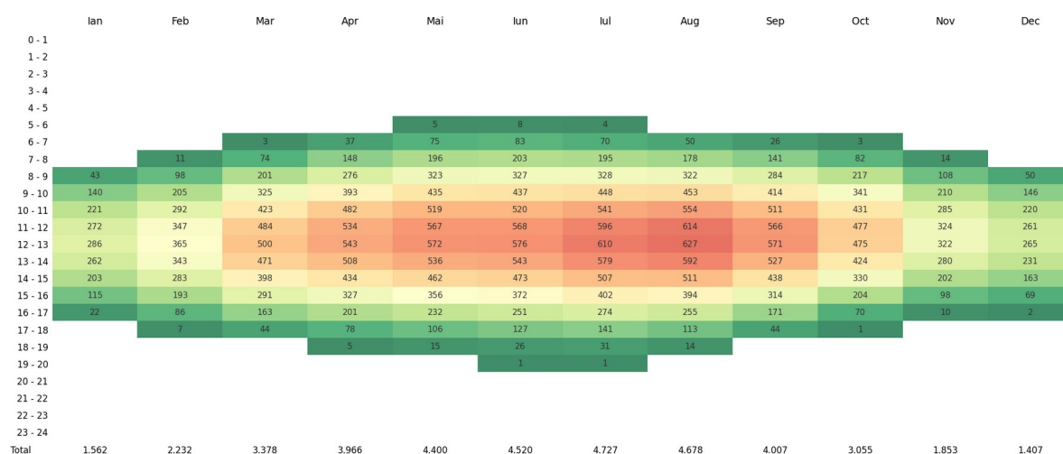
Figura 3. Producția fotovoltaică specifică orară medie, pe luni [Wh/kWp] – calcul pe baza simulării de producție și a geometriei solare a amplasamentului
